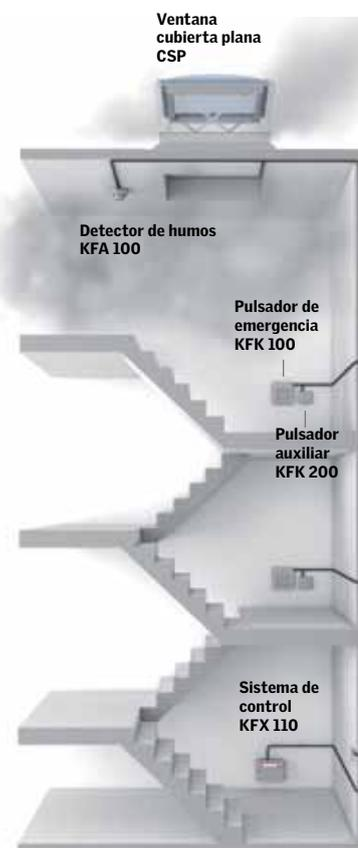
Componentes mínimos para el sistema de evacuación de humos y calor.
